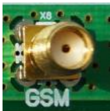
Рис. 4.3. SMA-разъем для подключения GSM-антенны
