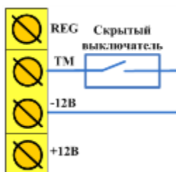
Рис. 7.2. Схема подключения скрытого выключателя
